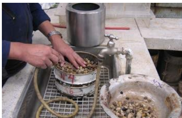
Figura 238 - 4. Lavado de la muestra y las esferas sobre los tamices
