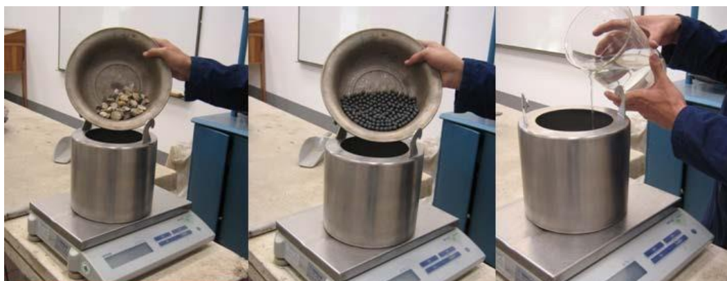
Figura 238 - 3. Colocación de la muestra, la carga abrasiva y el agua dentro del recipiente cilíndrico
